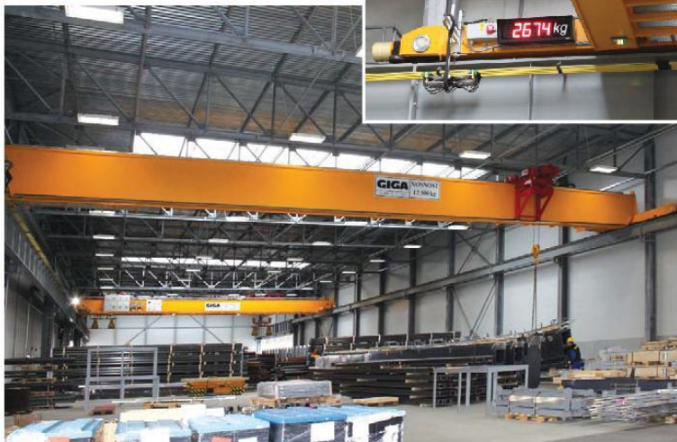
GKMJ 3,2t+3,2t/26,5m – jednoosníkový jeřáb s dvěma konzolovými kočkami s magnety v hale 7a
