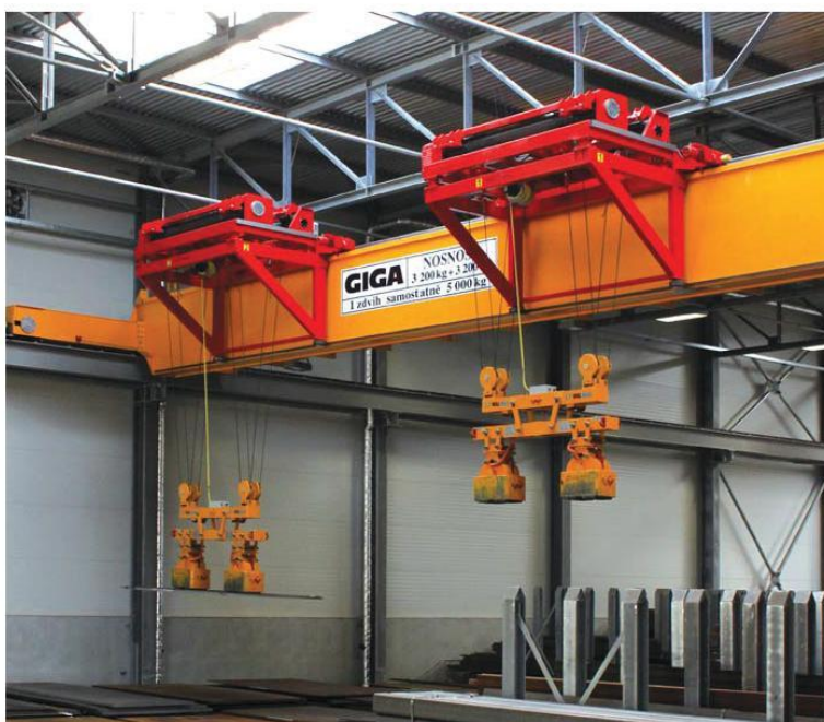
GKMJ 3,2t+3,2t/26,5m – jednoosníkový jeřáb s dvěma konzolovými kočkami s magnety v hale 7a
