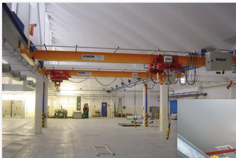
Podvěsné mostové jeřáby GPMJ 3,2t/10m
