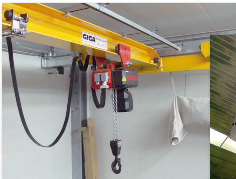
Elektrický řetězový kladkostroj CH1 500.4-JE instalovaný na podvěsném mostovém jeřábu GIGA typ GPMJ 2x 0,5t-4,2m. Zákazník - Benteler, s.r.o., Liberec, místo instalace - Rakousko
