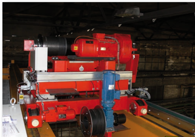
Mostový jeřáb GIGA typ GDMJ 20t/24,8m s otočnou kočkou
