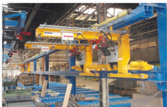
Konzolový pojízdny jeřáb GKMJ 0,16t/2,5m
