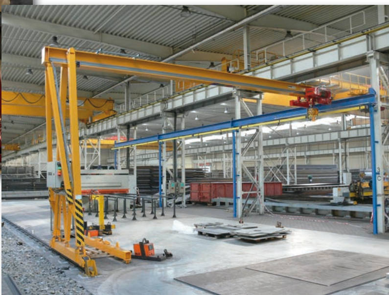
Poloportálový jeřáb GIGA typ GPMJ 5t/9,5m Zákazník - UnionOcel, s.r.o, Praha, místo instalace - provozovna Kopřivnice
