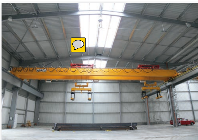
Dvounosíkový mostový jeřáb GDMJ 2x10t/25,5m s dvoukolinným kladkostrojem a lanovou stabilizací magnetové traverzy
