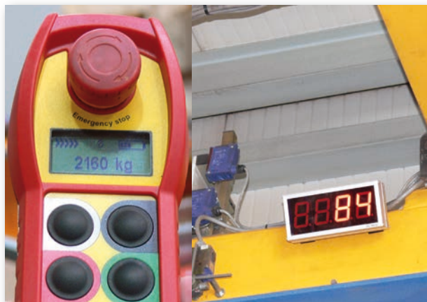
Zobrazení váhy na dálkovém ovladači a externím displeji
