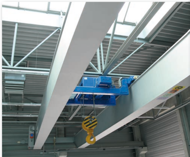
Dvounosíkový mostový jeřáb GDMJ 25t/22,6m se sníženou konstrukcí kladkostroje
