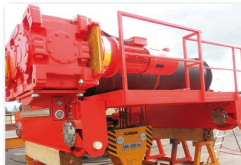
Vrátek GWF-165t pro mostový jeřáb GDMJ 165t/25t/12,5t/11,5m - elektrárna Počerady, CZ
