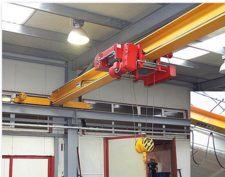
Jednonosníkový mostový jeřáb GIGA. Napájení kladkostroje energetickým kabelovým řetězem
