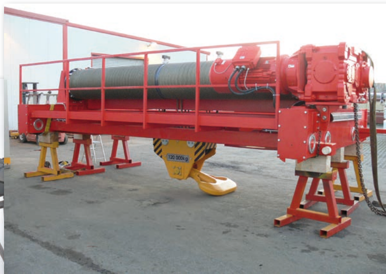
Vrátek GWF-120t o nosnosti 120t, který byl instalován na mostový jeřáb GDMJ 120t/50t/41,25m Místo instalace – elektrárna Ledvice, CZ
