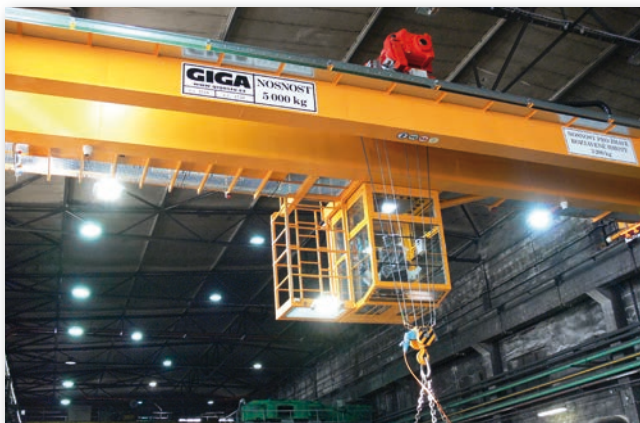
Slévarenský mostový jeřáb GDMJ 5t/16,5m s kabinou pro přepravu žhavých roztavených hmot do 3,2t s možností zavěšení drapáku nebo magnetu
