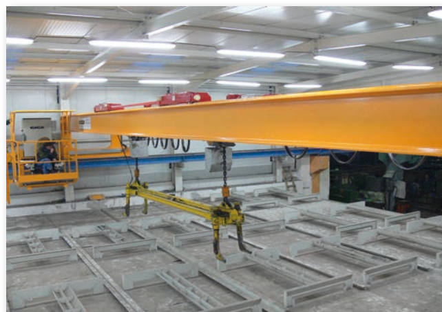
Dvounosíkový mostový jeřáb GIGA typ GDMJ 3,2t+3,2t/14m
