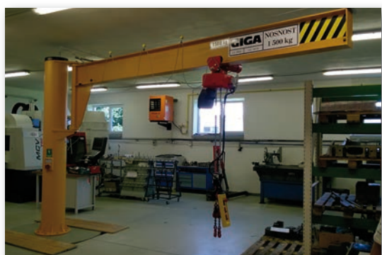
Sloupový otočný jeřáb GSOJ 1,5t/4,5m
