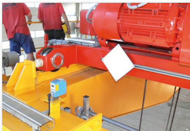
Mostový jeřáb GDMJ 12,5t/27,9m, vybavený pozicováním kladkostroje Místo instalace: Presbeton, s.r.o., Olomouc
