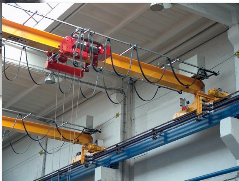
Jednonosníkové mostové jeřáby GIGA s technologickým vážením břemene
