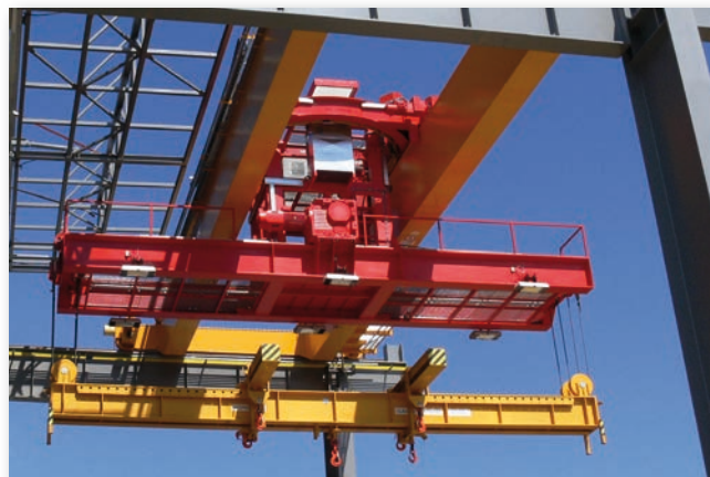
Dvounosíkový mostový jeřáb GDMJ 50t/15,4m s otočnou kočkou a traverzou
