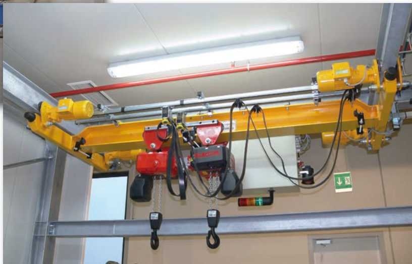
Podvěsný mostový jeřáb GPMJ 2x0,5/4,2m
